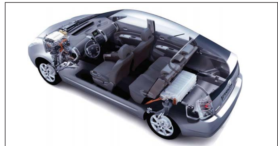
Bild 24: Aufbau des Hybridsystems im Toyota Prius II; Quelle: Toyota
