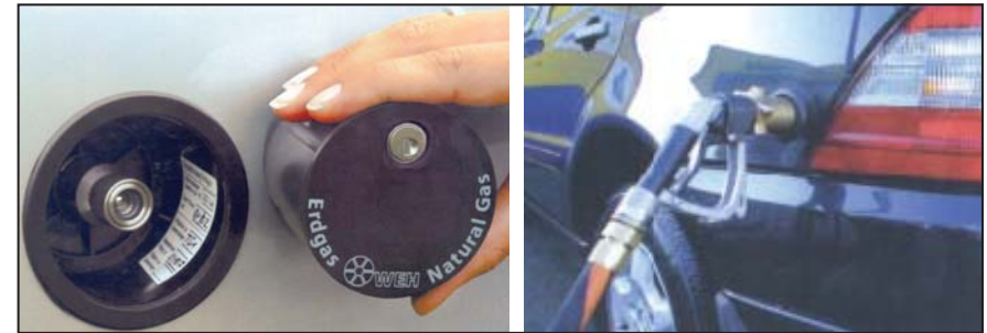
Bild 5: Füllstutzen für CNG (links) und für Flüssiggas (rechts);
