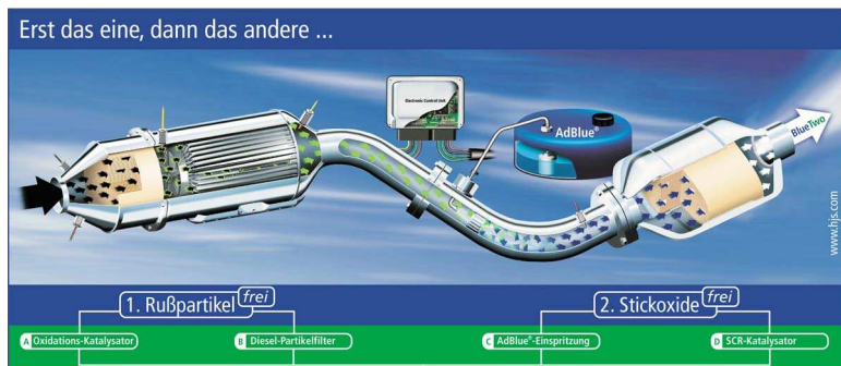
Abb.: SCR-Katalysator (selective catalytic reduction) = Selektive katalytische Reduktion von Stickoxiden
