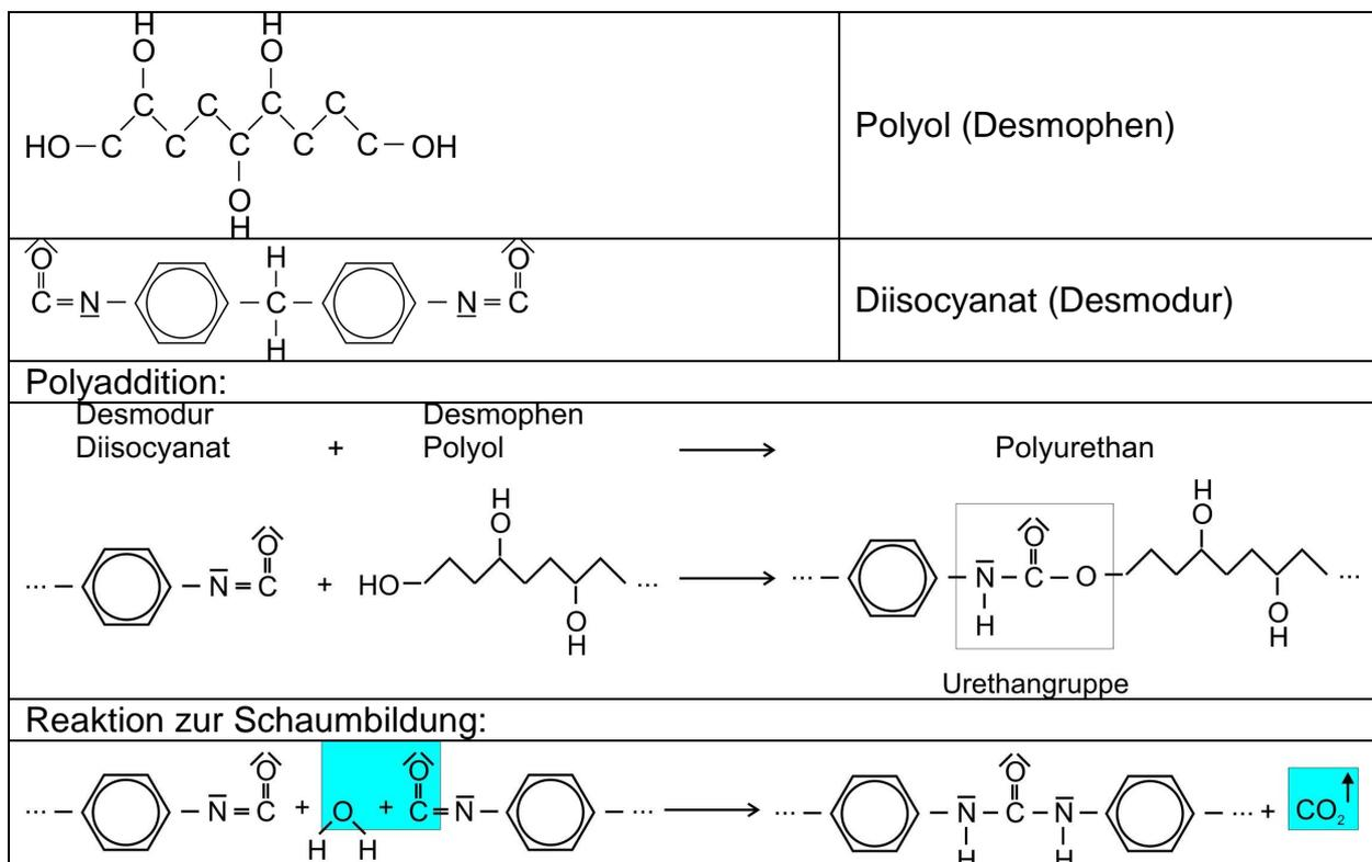
Man bezeichnet das Kohlenstoffdioxid bei dieser Art der Schaumbildung als chemisches Treibmittel, weil es durch Reaktion gebildet wird. Im Unterschied dazu gibt es auch Schaumstoffe, die durch physikalische Treibmittel aufgebläht werden, das sind niedrig siedende Zusatzstoffe, die durch die Reaktionswärme der Kunststoffbildung gasig werden.
